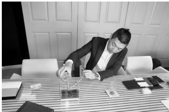
ヘルスコートの上から水を入れても下へは通らない
